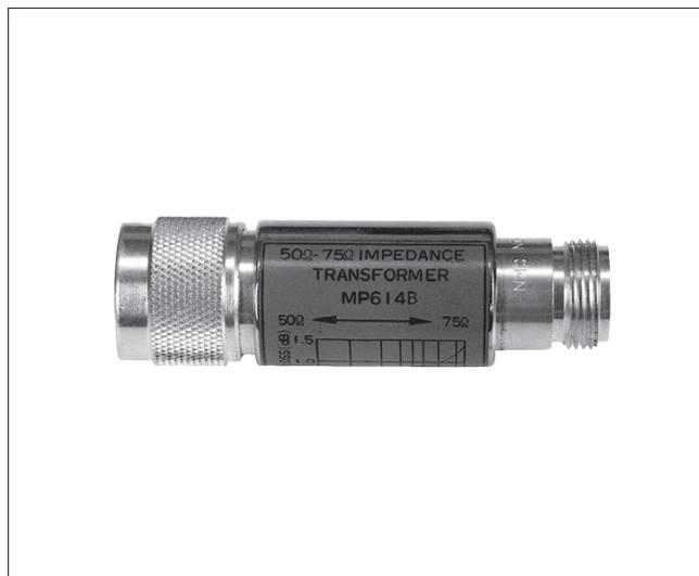
MP614B 50 Ω ↔ 75 Ω インピーダンス変換器は、50~1200MHzの範囲で、主として信号発生器などの測定用信号源のインピーダンスを変える場合に用いられます。トランス型のため、抵抗減衰器型に比べて損失が少なく、信号源のレベルが実質的に低下するという欠点がありません。信号発生器の出力レベルがdBmなど電力単位で表示されている場合は、MP614Bでインピーダンス変換した後の出力レベルは、信号発生器の出力レベルからインピーダンス変換器の挿入損失を差し引いた値となります。MB-009は本素子の75 Ω側に、うっかりして50 ΩのN型プラグを接続しても、ジャックの中心コンタクトが破損しない構造になっています。
