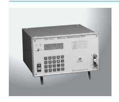
デジタル式ディケード標準抵抗器は本体にCPUを内蔵し、コンピュータで制御するリモートモード、また はローカルモードで簡単に任意の抵抗値が設定可能です。更に、白金測温抵抗体Pt100等の各温度 における抵抗値が記憶されており、自動計測による測定時間の大幅短縮及び経費節減が可能です。 抵抗素子には温度係数、長期安定性等で高い評価を得ている当社の超精密金属箔抵抗器を使用 し、更に二重シールド構造等により高精度、高安定を実現した製品です。
