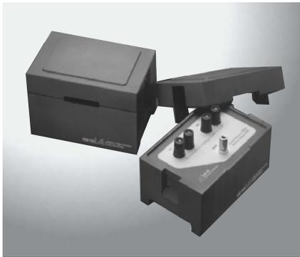
ASRシリーズは抵抗エレメントに弊社独自の高安定で低抵抗温度係数のNi-Cr合金箔を採用した高安定な標準抵抗器です。従来より標準抵抗器の製作には高度の熟練者を要しており、性能のバラツキも懸念されます。弊社では長年の金属箔抵抗器で培った厳重な品質管理や安定化処理技術を通してバラツキの無い安定した製品を提供致します。金属箔の持つ卓越した抵抗温度係数は、高価でメンテナンスの煩雑なオイルバスなどの温度調節設備の設置を必要とせず、気中使用が可能です。作業現場の精密測定、校正用として、また社内トレーサビリティの照合用として、幅広い分野での利用が可能です。筐体は小型で堅牢な本体とカバーからなり、ターミナルの損傷や保管等に配慮した構造となっています。
